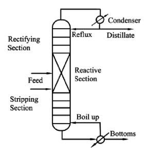
Figura 1; Esquema de una unidad de destilación reactiva
