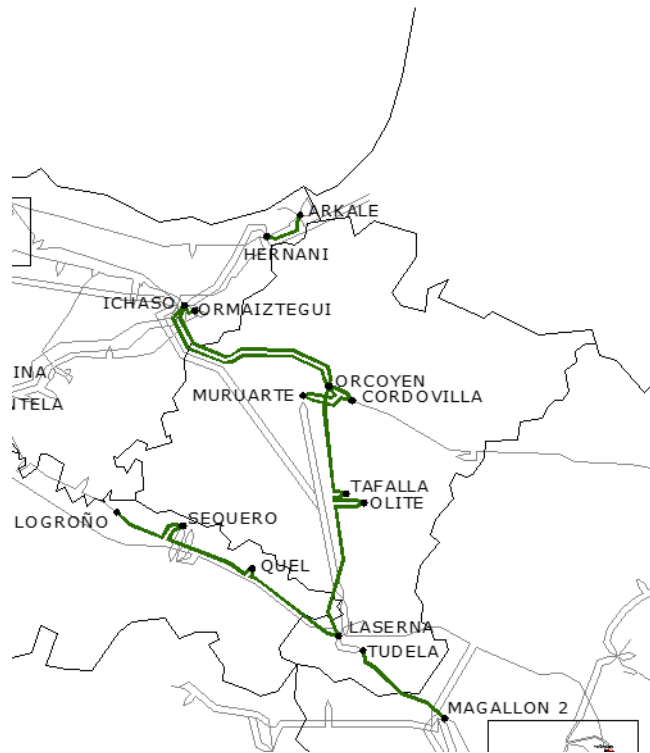
Nuevo eje de 400 kV entre Navarra y el País Vasco
