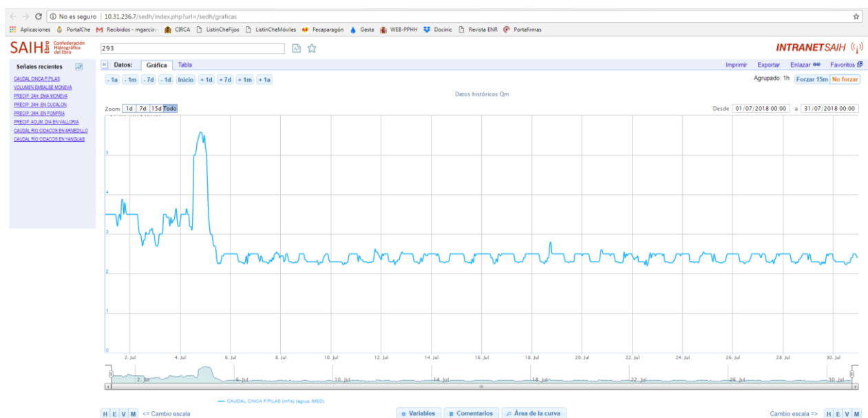
Figura 1: Caudales registrados cada 15 minutos en la estación de aforos 293 del río cinca en Puente de Las Pilas en el mes de julio de 2018
