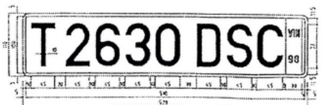
Matrícula turística larga Fondo blanco. Caracteres negro mate Banda: Fondo rojo. Caracteres blanco mate adhesivos
