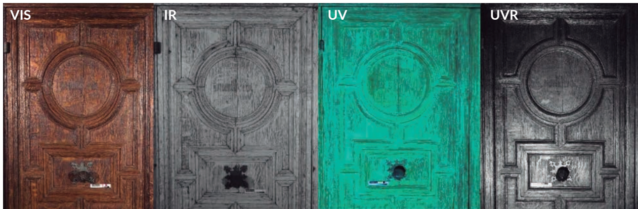
Figura 4. Estudio con luz visible (VIS), luz infrarroja (IR), luz ultravioleta (UV), luz ultravioleta reflejada (UVR).
